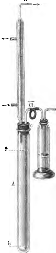
Darstellung von wasser- freiem Zinnchlorid.
